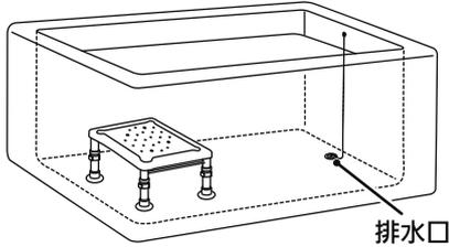
②使用前に浴槽台を上から押し付けミニ吸盤を浴槽底に密着させてください。
